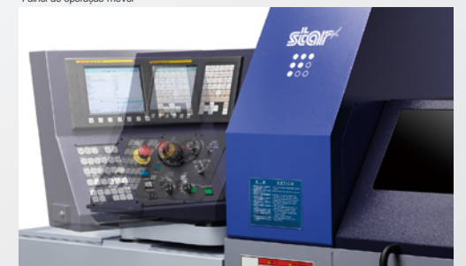
Painel de operação móvel
