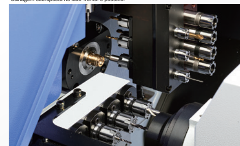
Usinagem sobreposta no lado frontal e posterior
